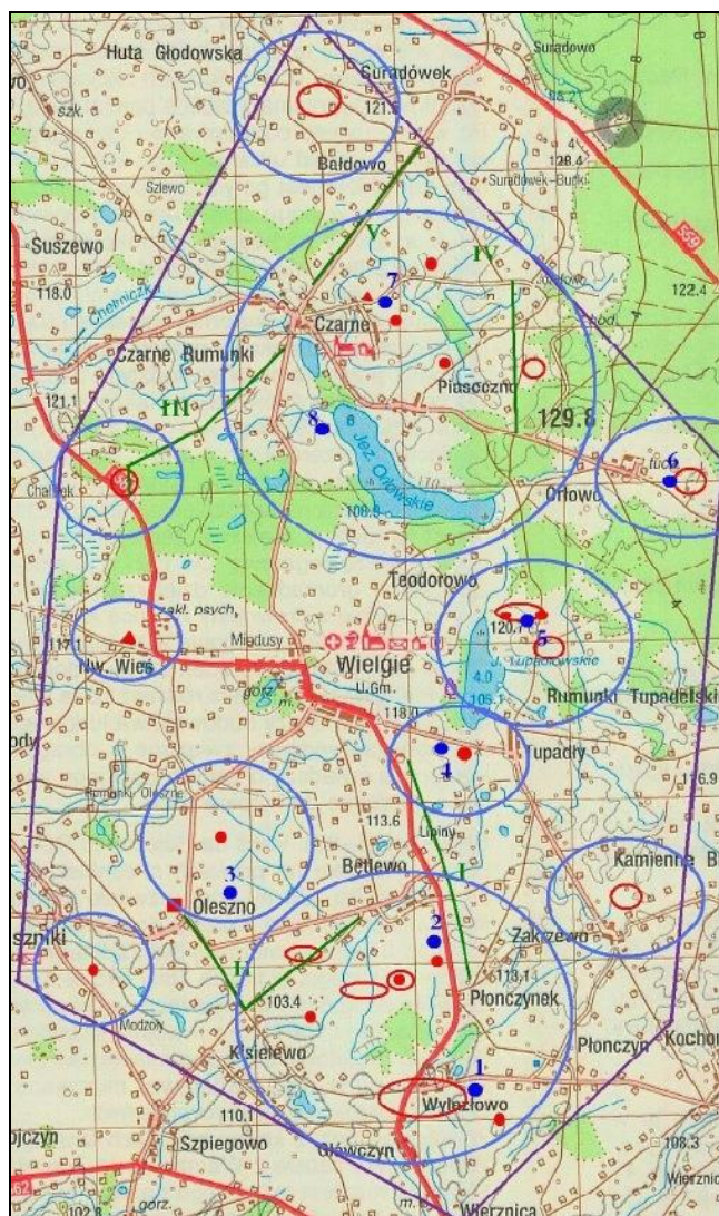
Rys. 2. Obszar planowanej farmy wiatrowej 'Wielgie' wraz z terenem buforowym - granica oznaczona kolorem fioletowym; punkty czerwone i obszary ograniczone czerwoną linią – miejsca planowanych lokalizacji siłowni; obszary ograniczone niebieską linią – obszary otulinowe; 1 - 8 – punkty obserwacyjne; I - V – trasy transektów; Linie zielone – trasy transektów; punkty niebieskie – punkty obserwacji stacjonarnych. Bok kwadratu siatki geograficznej – 2 km. Źródło: Cisakowski R., (2010)
