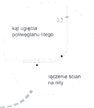
DETAL ŁĄCZENIA ŚCIAN
